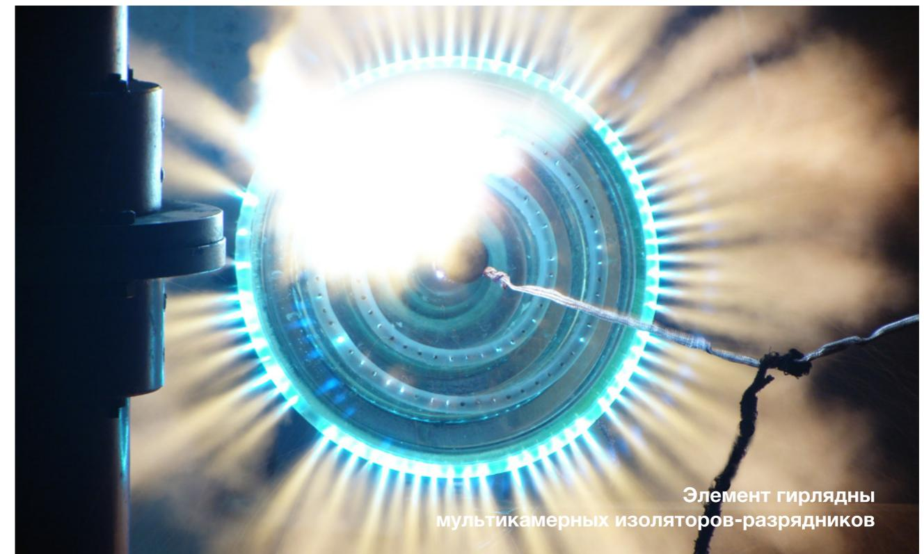
В 2013 году ФСК завершила трехлетнюю опытно-промышленную эксплуатацию принципиально новых устройств защиты линий электропередачи в грозовой период – гирлянд мультикамерных изоляторов-разрядников. Применение этого инновационного приспособления сведет к минимуму аварийные отключения линий электропередачи во время грозы и позволит отказаться от использования грозотроса, сократив тем самым эксплуатационные затраты Компании.
